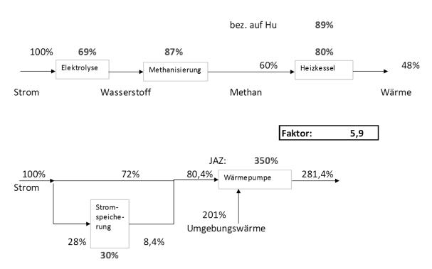
Vergleich der Wirkungsgradkette "Strom zu Heizwärme" über den Brennstoffpfad und über den Strompfad
