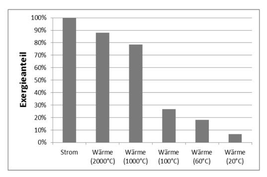
Exergieanteil von Strom (stets 100 %) im Vergleich zu Wärme auf unterschiedlichen Temperaturniveaus (Umgebungstemperatur 0 °C)
