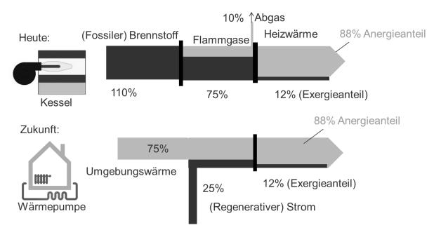
Heizwärme aus Heizkessel (oben) oder aus der Wärmepumpe (unten). Die schwarzen Balken stehen für die verlustbehafteten Prozesse, in erster Linie die Verbrennung und die Wärmeübertragung
